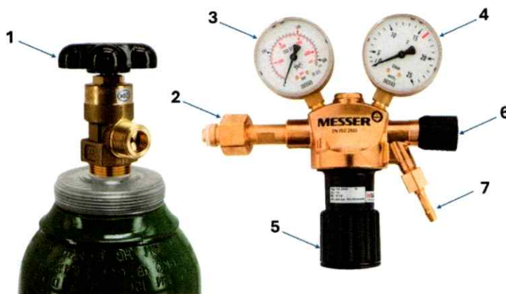
Слика 2. Боца и редукциони вентил. (1-вентил боце, 2-холендерска матица, 3 и 4-манометри, 5-вентил за подешавање притиска, 6-излазни вентил, 7-излаз за црево)
